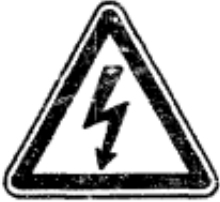
Gevaar voor elektrische spanning
